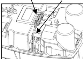
Устройство имеет однофазную 230 В 50/60 Гц. линию питания. Электрическая система, к которой будет подключено оборудование, должна отвечать требованиям безопасности и должна быть оснащена:
