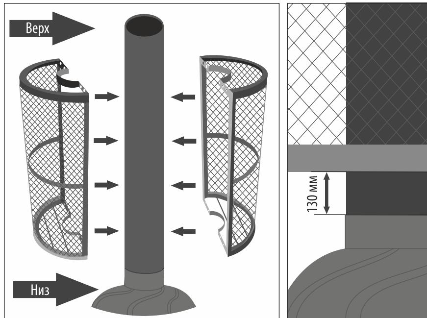
2. Закрепите с помощью болтов конструкцию на дымовой трубе:
