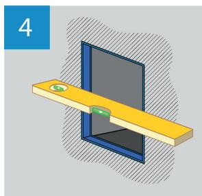
Выровняйте положение рамы в проеме с помощью строительного уровня
