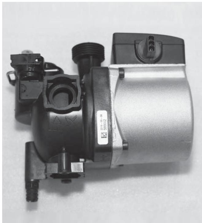
Циркуляционный насос с мокрым ротором предназначен для циркуляции теплоносителя по системе отопления. Насос установлен на обратной линии теплоносителя. Для адаптации к системе отопления насос имеет регулятор скорости на 3 положения. В клеммной коробке циркуляционного насоса встроен конденсатор номиналом 2,5 мкФ.
