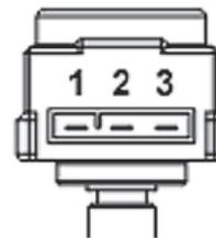
Сервопривод трехходового линейного клапана переключает направление потоков теплоносителя от контура отопления к пластинчатому теплообменнику ГВС и наоборот. Так как при нагреве пластинчатого теплообменника ГВС котел замкнут на малый контур, отопление не работает. При переключении котла из режима нагрева ГВС в режим отопления скоростной теплообменник не греется.
