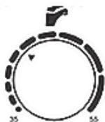
При запросе потребления горячей воды котел автоматически перейдет в режим нагрева «ГВС». Ручкой регулировки на панели управления устанавливается температура от 35 до 55 °С. В режиме ГВС на дисплее отобразится
