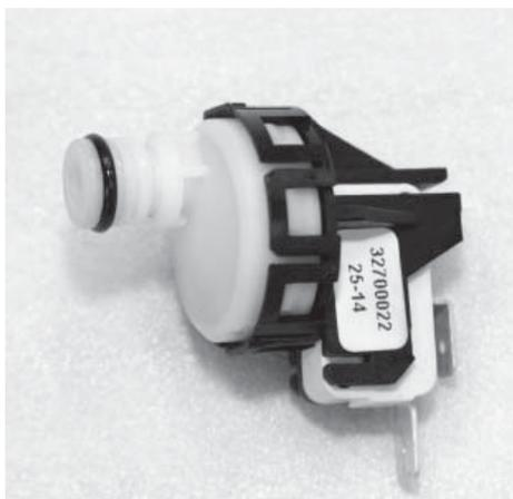
Реле давления теплоносителя предназначено для ограничения работы котла при падении давления теплоносителя. При неисправности котла по давлению теплоносителя на дисплее отображается код неисправности «LP».
