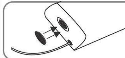
**RUS** Надеть уплотнительную прокладку на корпус спускной арматуры.
