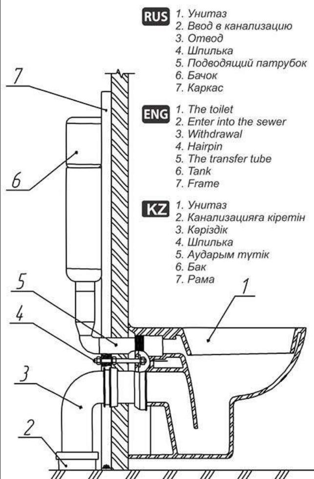
**RUS** Произвести предварительную разметку места установки унитаза. Раму можно смонтировать на любой высоте от пола. Рекомендуется отрегулировать каркас таким образом, чтобы расстояние от сливного бачка до пола было примерно 1 метр. Расстояние от верхней поверхности чаши до пола определяют индивидуально (ориентировочно для взрослого человека оно составляет 40 см.)
