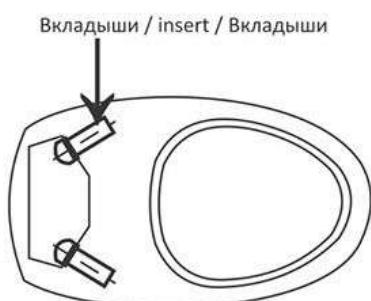
**RUS** Некоторые модели унитазов комплектуются вкладышами (2 шт. или 4 шт.). Вкладыши устанавливаются во внутреннюю полость унитаза и обеспечивают лучшее и более полное ополаскивание. Один вкладыш нужно ввести по плечики в левое отверстие полочки, другой – в правое.
