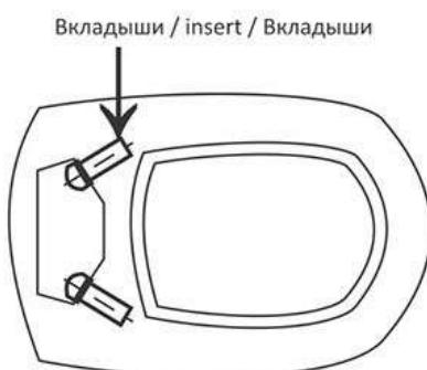
**RUS** Некоторые модели унитазов комплектуются вкладышами (2 шт. или 4 шт.). Вкладыши устанавливаются во внутреннюю полость унитаза и обеспечивают лучшее и более полное ополаскивание. Один вкладыш нужно ввести по плечики в левое отверстие полочки, другой – в правое.
