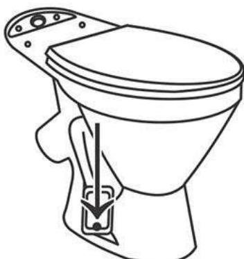
**RUS** Произвести разметку крепления унитаза к полу. Закрепить унитаз к полу при помощи специального комплекта крепежа. Внимание! Запрещается устанавливать изделие на свежеуложенный пол.
