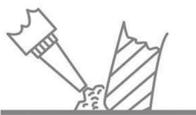
**RUS** Обработать место постамента унитаза с полом силиконовым герметиком, чтобы предотвратить попадание воды под основание унитаза.
