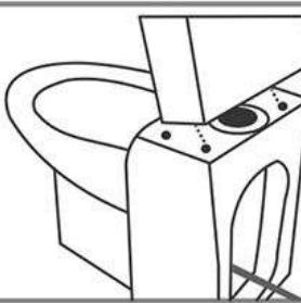
**RUS** Прикрепить при помощи крепежных болтов бачок к унитазу.
