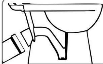
**RUS** Произвести соединение унитаза с канализационной сетью при помощи гофрированного или цельнолитого пластикового отвода.
