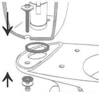
**RUS** Надеть уплотнительную прокладку на корпус сливной арматуры. Установить бачок с арматурой на полочку унитаза и прикрепить его с помощью крепежных болтов.
