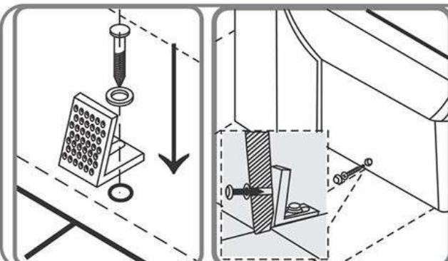
**RUS** Закрепить унитаз к полу при помощи специального комплекта крепежа (боковое крепление).
