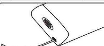
**RUS** К наполнительному клапану бачка присоединить шланг подводки воды.
