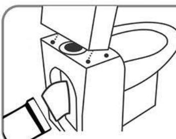
**RUS** Произвести соединение унитаза с канализационной сетью при помощи гофрированного отвода (гофры).
