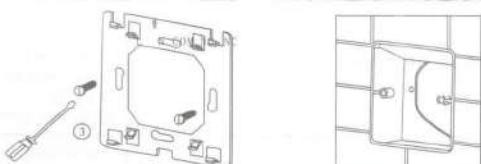
4. После подключения терморегулятора к проводам, закрепите прибор на крепежной пластине (см. рис.), наденьте лицевую панель и рамку.
