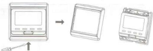
2. Снимите заднюю крепежную пластину, как показано на рисунке.
