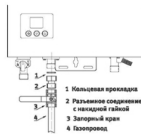
Подсоединение газопровода
