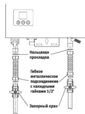
Подсоединение водопровода
