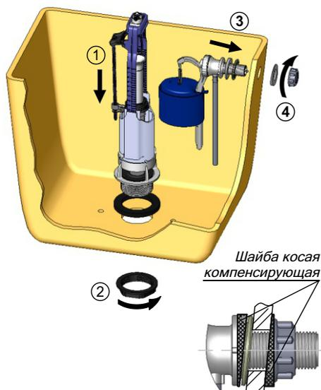
При затягивании гайки 9 (рис.1) не превышайте максимально допустимый момент 3 Нм.
