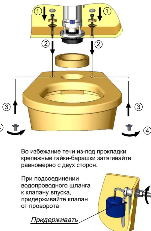
Во избежание течи из-под прокладки крепежные гайки-барашки затягивайте равномерно с двух сторон.
