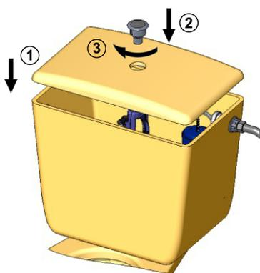
Проверьте чтобы между крышкой бачка и кнопочным узлом, вставленным до упора в резьбу клапана выпуска (не винчивая), был зазор 3...19 мм. См. раздел "Регулировка арматуры"
